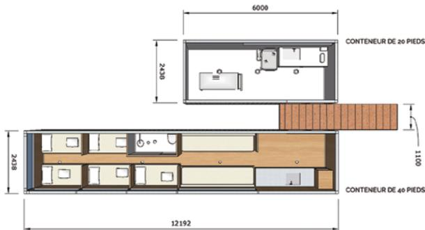
Les modules sont fabriqués à partir de conteneurs maritimes. Deux tailles sont utilisées : le module de vie est un conteneur de 40 pieds et le module de soins est un conteneur de 20 pieds. Il s'agit dans les deux cas de tailles standards.
